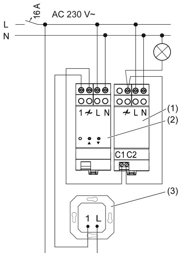
Imagen 1: Ejemplo de aplicación con ampliación de potencia
