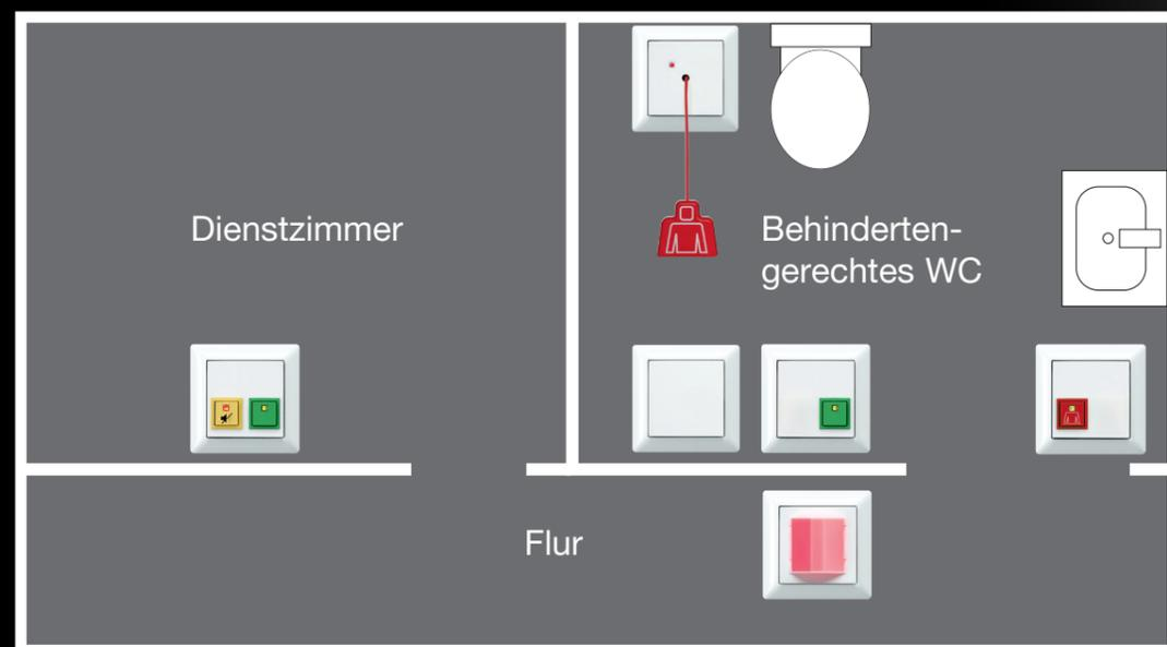
Mithilfe des Zugtasters und des Tasters am WC wird ein optischer und akustischer Alarm ausgelöst und vor den Toilettenräumen angezeigt. Daneben kann optional eine Dienstzimmereinheit installiert werden, die ein zusätzliches Signal in einem weiteren Raum ermöglicht.
