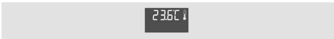
Bild 20: Anzeige der Ist-Temperatur
