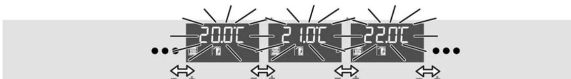
Bild 10: Einstellen der Basistemperatur
