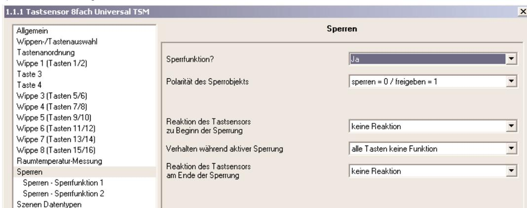
Die Polarität des Sperrobjects ist parametrierbar. Bei invertierter Polarität (sperren = 0 / freigeben = 1) ist nach einem Reset oder nach einem ETS-Programmierungsvorgang die Sperrfunktion nicht sofort aktiviert (Objektwert = "0"). Es muss erst ein Objektupdate "0" erfolgen, bis dass die Sperrfunktion aktiviert wird.
