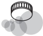
Jeder Alarmton lässt sich durch Betätigen der Prüf-/Stopp-Taste (Seite 12, Abb. 1, Punkt d) vorübergehend deaktivieren (Rauchalarm und Temperaturalarm: 10 min).
