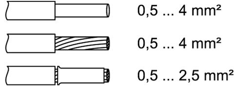
Bild 5: Klemmbare Leiterquerschnitte
