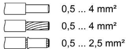
Bild 9: Klemmbare Leiterquerschnitte Lastausgänge und Spannungsversorgung
