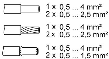
Bild 5: Klemmbarer Leiterquerschnitt
